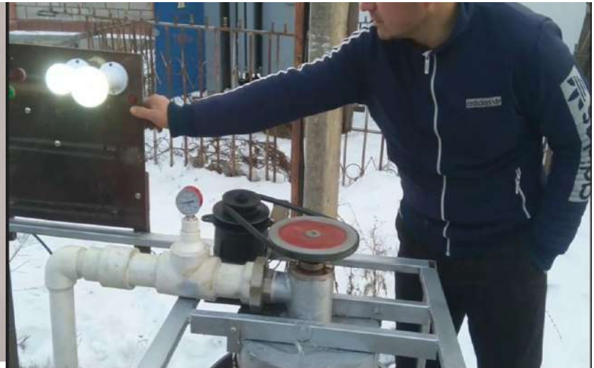
4-rasm. Ichki yo’naltiruvchi konstruksiyali gidroturbina tajriba sinov modelini stendda sinash jarayoni
