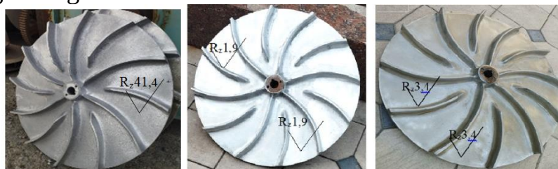
1-rasm. Xozirda ishlatilayotgan ventilyatorning ishchi parragi
