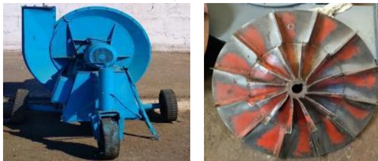
1-rasm. Chap tomonda xarakatlanuvchi VS-8M va o'ng tomonda ventilyator ishchi parragi ko'rinishi.
